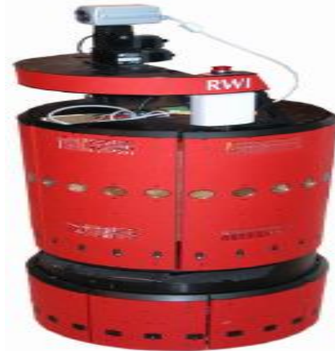
شکل 2: دوربین و فاصله‌یاب لیزری نصب شده بر روی ربات متحرک [19]
